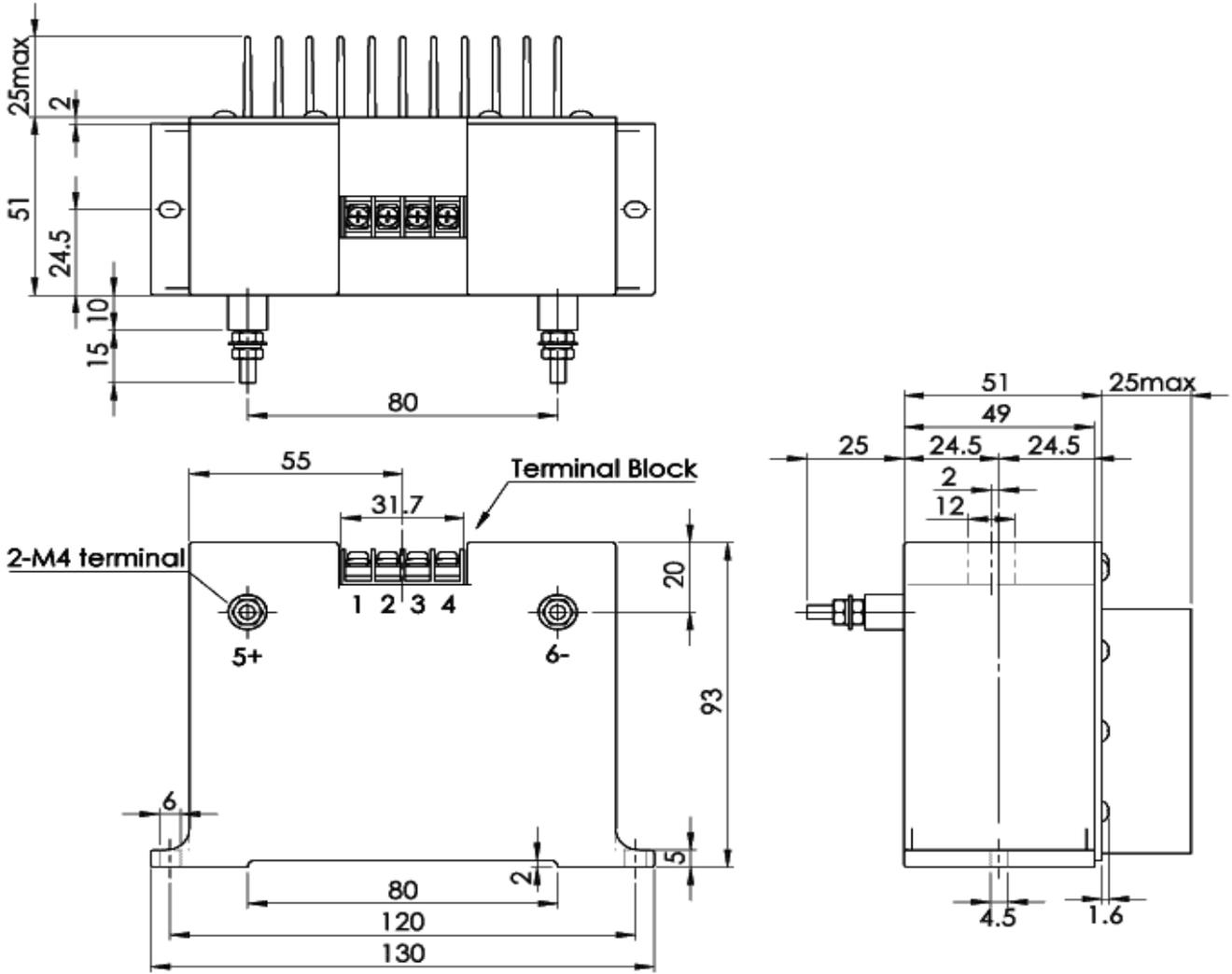
Terminal Block 型式[F2060AX-4P(M3)] メーカー[フジコン]
